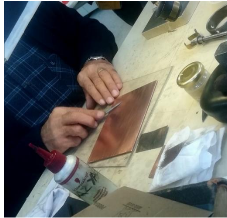
Şekil 19. Yüzeyin Parlatılması, Kaynak: Kişisel arşiv
