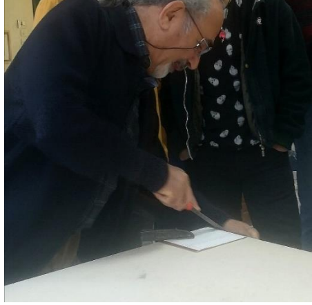
Şekil 18. İşkence ile Sabitlenen Bakır Levhannın Köşelerinin Pahlanması, Kaynak: Kişisel arşiv
