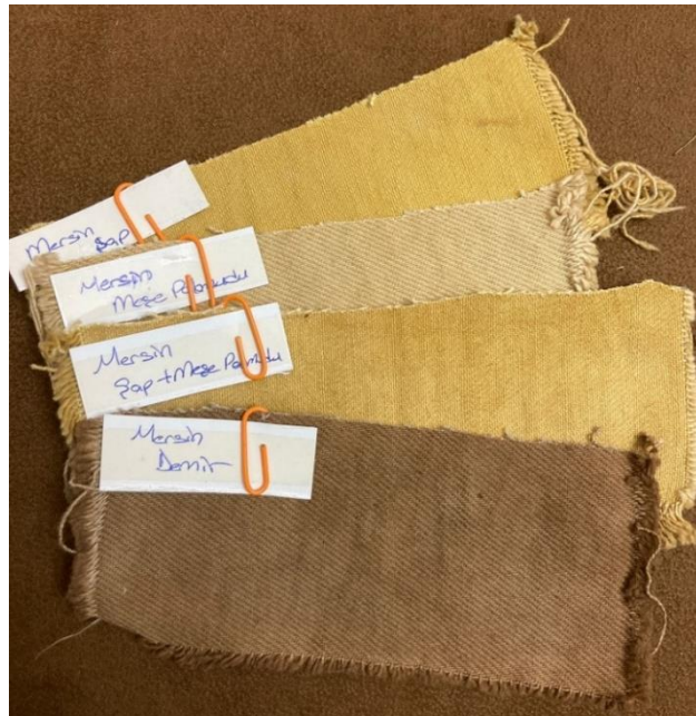
Fotograf 13. Mersin Bitkisi (Myrtus), Azo boyarmadde testi için numuneler, (Özdoğan, Isparta, 2022).
