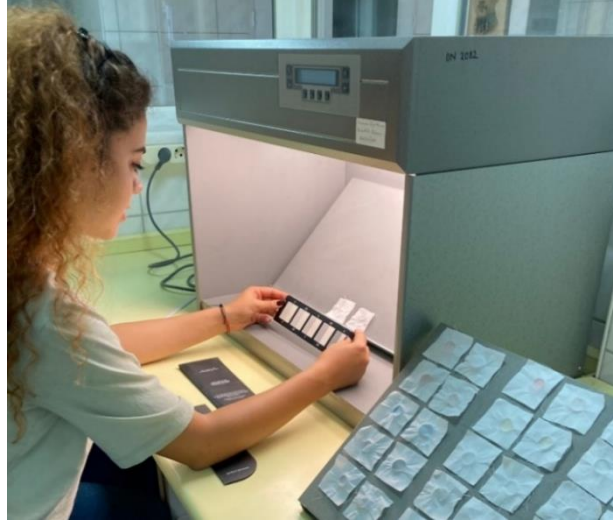
Fotoğraf 10. Mersin Bitkisinin D65 Gün Işığ Kabininde Numunelerin Haslık Değerlendirilmesi, (Özdoğan, Isparta, 2022)
