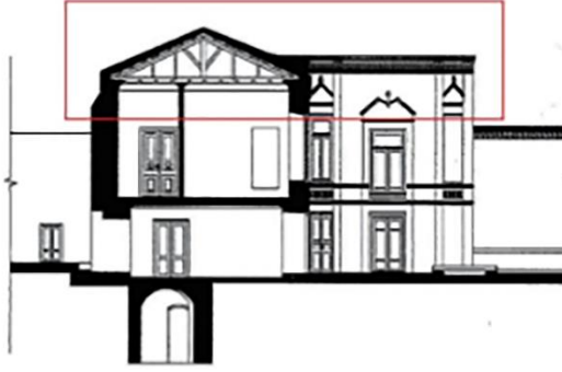
Şekil 11. Tebriz Geleneksel Konutunda Az Eğimli Çatı ve Eğimli Çatının Birlikte Kullanımı (Kesit) (Hariri Konutu) (Ahmadpour, 2015).
