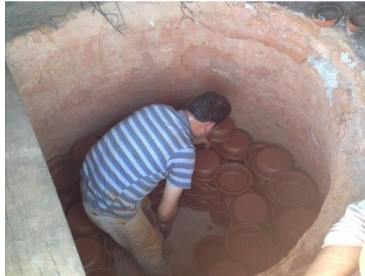
Res.14: Fırın Yerleştirme Aşaması (Fotoğraf: Altıncılıç, 2012, Karacasu)
