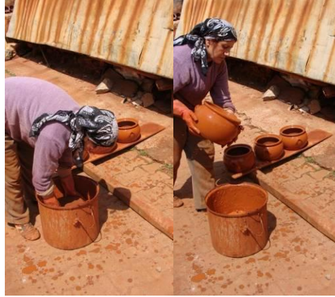
Res.8: Daldırma Yöntemi ile Astarlama İşlemi (Fotoğraf: Altıncılıç, 2012, Karacasu)
