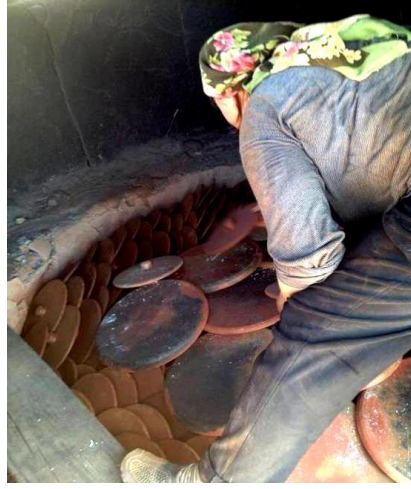
Res.15: Daha önceden pişirimi yapılmış kullanılmayan kırık çömllek parçaları ile fırının istiflenmesi işlemi (Fotoğraf: Altınkılıç, 2012, Karacasu)
