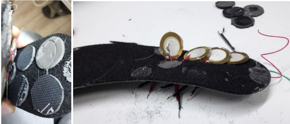
Şekil 5. Piezoelektrik malzemenin yerleştirilmesi
