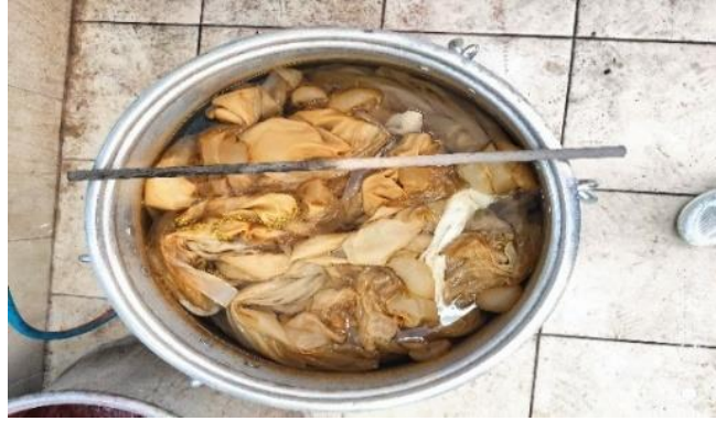
Fotoğraf 4. İpek Kumaşların Demir (II) Sülfat ( \text{FeSO}_4 \cdot x\text{H}_2\text{O} ) ile Mordanlanması, Fotoğraf: Meral Orhan
