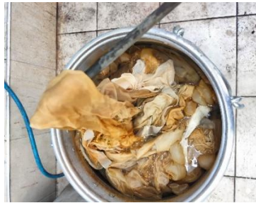
Fotoğraf 14. İpek Kumaşı Önceden Mordanlama İşlemi, Fotoğraf: Meral Orhan, 2022
