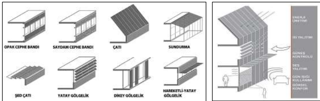
Şekil 22. Fotovoltaik Sistemlerin Cephe ve Çatı Yüzeylerinde Kullanım Biçimleri ve Binaya Entegre Sistemler (Yılmaz vd., 2015:112-113)
