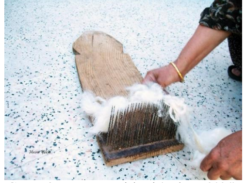
Görsel 3. Yün tarama işlemi (Çolpan, 2024)
