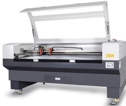
Fotoğraf 16. Lazer Kesim ve Kazıma Makinesi, Kaynak: URL 7
