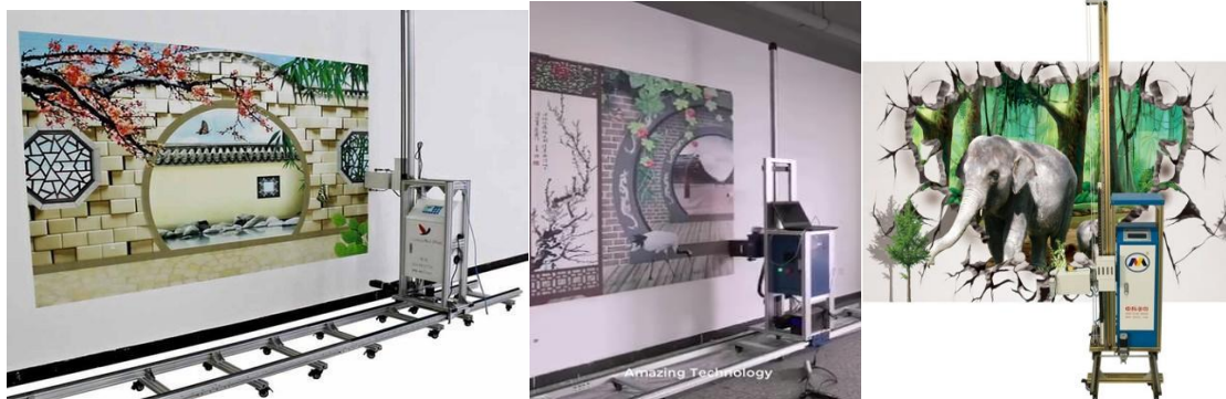
Görsel 16. Otomatik Duvar Boyama Makinesi Wall İnkjet Printer, (URL 20)
